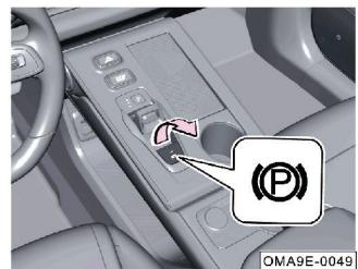
اگر ترمز خودرو عمل نکرد، کلید ترمز پارک را به طور متوالی بکشید تا نیروی لازم برای ترمزگیری اضطراری خودرو توسط سیستم ترمز پارک برقی اعمال شود. در این شرایط چراغ نشانگر قرمز رنگ ترمز پارک در صفحه کیلومترشمار به صورت چشمک زن روشن خواهد شد. پس از خارج شدن از وضعیت ترمزگیری اضطراری، کلید ترمز پارک را رها کنید.
