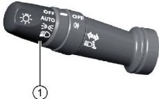
هنگامی که موتور در حالت ON است، با چرخاندن کلید انتهایی ① اهرم چراغ و راهنمای توانید چراغ ها را روشن کنید.
