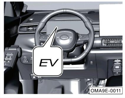
لامپ نشانگر EV زمانی روشن می شود که فقط موتور محرک برای راندن وسیله نقلیه کار می کند یا موتور خاموش است.
