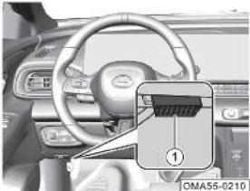
محل نصب دستگاه عیب یاب ۱ رابط OBD برای خواندن شماره شناسایی الکترونیکی خودرو (VIN) در قسمت پایین سمت چپ عقب پنل ابزار قرار دارد. داده‌هایی مانند شماره شناسایی الکترونیکی خودرو و اطلاعات وضعیت خودرو می‌تواند از طریق ابزار اسکن ویژه‌ای خوانده شود.
