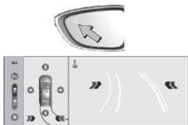
سیستم BSD از طریق چندین روش به راننده هشدار می‌دهد:
